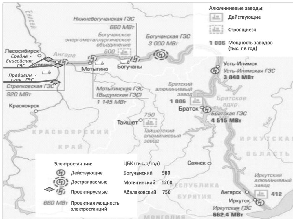
Рис. 1. Схема размещения действующих и проектируемых ГЭС, ЦБК и алюминиевых заводов в Ангаро-Средне-Енисейском регионе ([8 12, 14] и дополнения автора)
